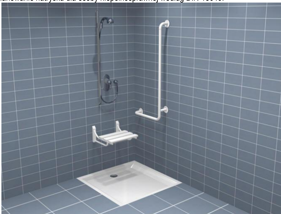
Rys.1 i 2. Planowanie natrysku dla osoby niepełnosprawnej według DIN 18040.
