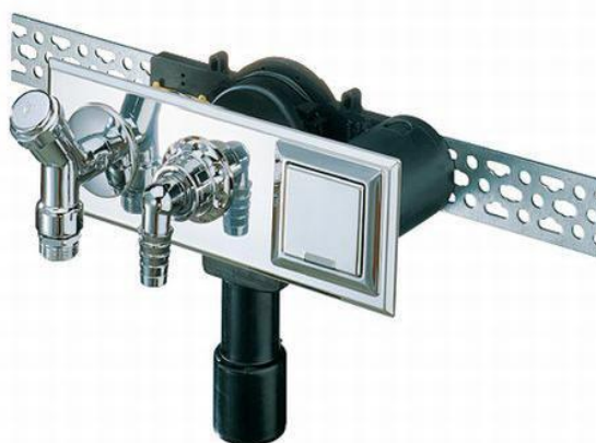
Fot. Zestaw podtynkowy do pralki z przyłączem wodociągowym, syfonem podtynkowym i wodoszczelnym gniazdem elektrycznym
